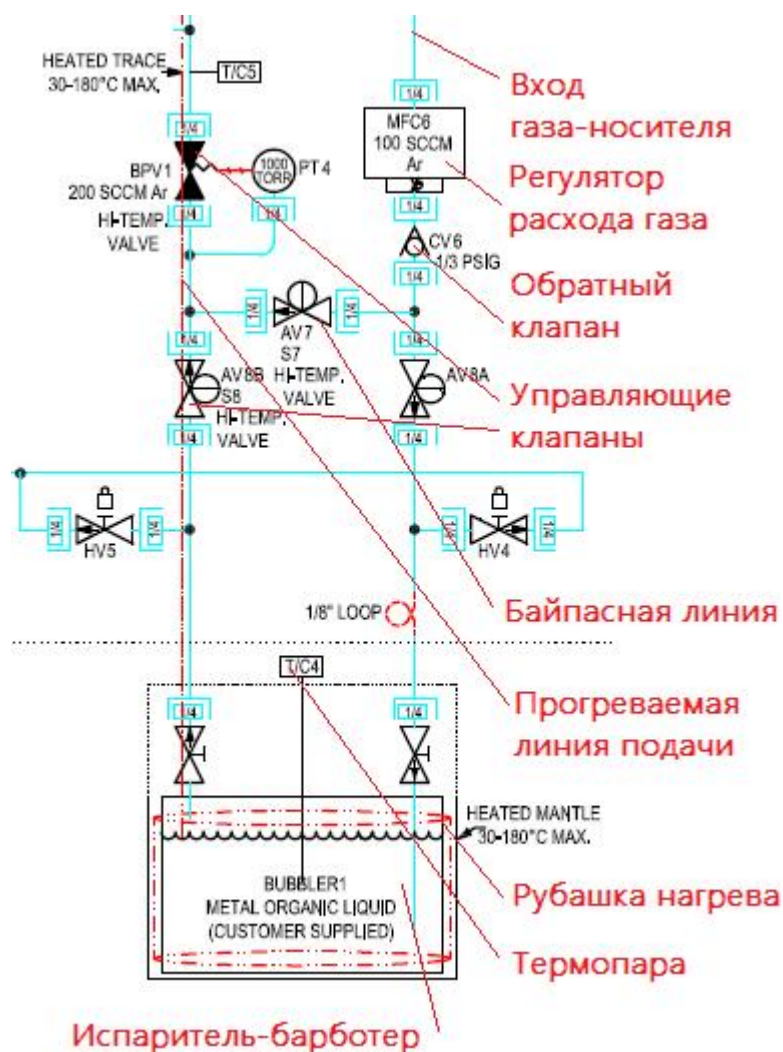
Рис. 4 Схема доставки жидкого прекурсора на примере установки EasyTube_3000
