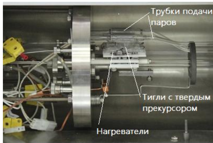
Фото 4. Пример подачи паров твердых прекурсоров
