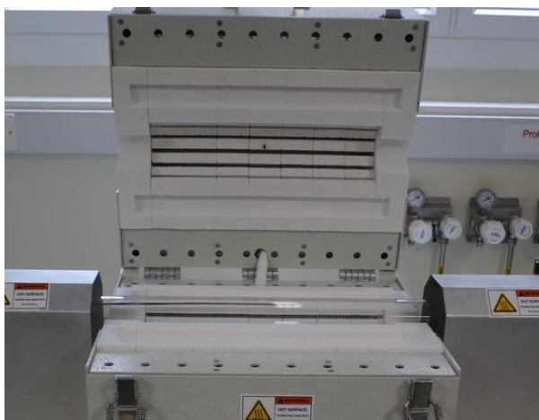
Фото 1. Резистивный нагревательный модуль CVD-установки корейской компании PlanarTech
